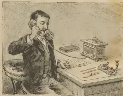
Fig. 3. - Manera de usar el micro-telefono del ejército alemán.
